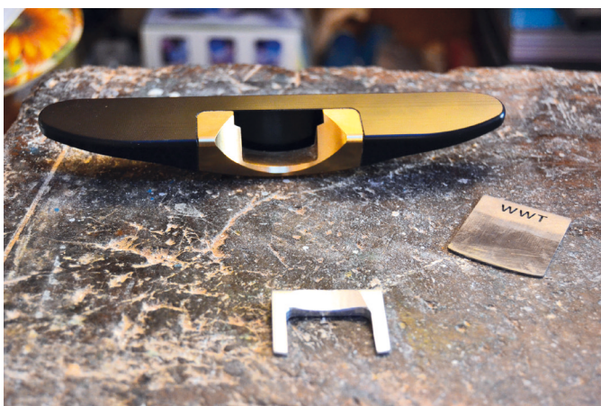
Il Traviscraper è una rasatura inserita in una struttura che la sostiene. La lama è montata verticalmente e si fissa al corpo tramite un cuneo in alluminio.
