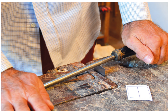
Per affilare la lama si procede come nelle comuni rasature: lima, pietre e poi brunitoio. La dima data in dotazione mostra la curva che deve essere mantenuta sulla parte tagliente.
