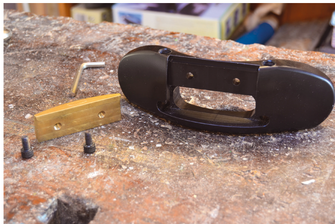
Il corpo in Delrin del Travisher privato della lama e della suola in ottone.
