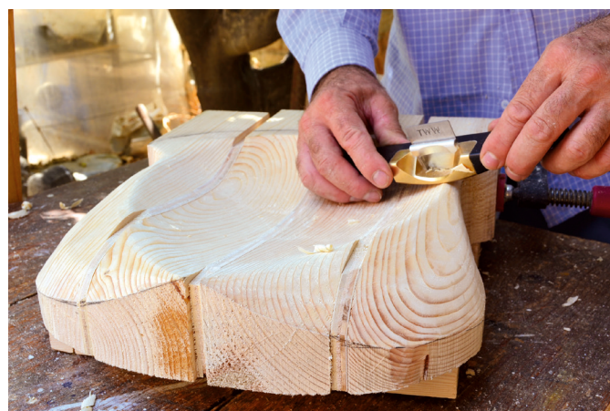
L'ampia impugnatura e la stabilità nell'uso del Traviscraper permettono di impiegare lo strumento anche nella rifinitura di superfici convesse.
