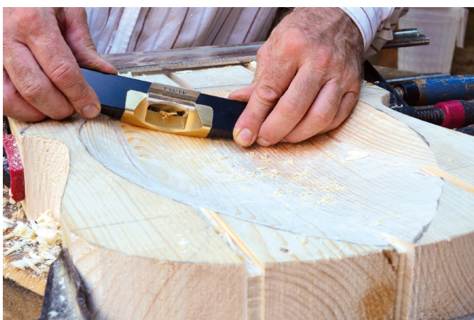
Il Traviscraper elimina anche le più piccole asperità lasciate dal Travisher. Risulta leggero e maneggevole con una suola che bene si adatta alle diverse curve che la seduta presenta.
